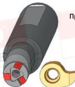
3-точечная фиксация гарантирует точное расположение пластин и режущей кромки. Однако необходимо контролировать высоту режущей кромки особенно при обработке малых диаметров для избежания поломки пластин.
